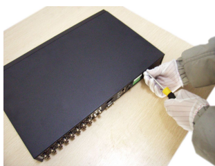
①拆卸主機上蓋的固定螺絲
