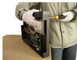
③安裝固定硬盤螺絲
